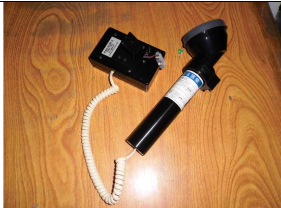
照片 4-30 核医学科表面污沾仪
